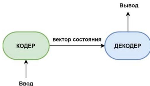
Рисунок 10. Обобщенная модель кодировщик-декодировщик
